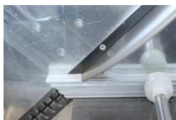
Assemblage de profilés LED
