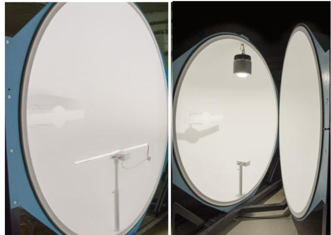
Sowohl im Rahmen der obligatorischen QS-Tests als auch zur Klassifizierung der Nennlebensdauer werden bei ISOLED® sämtliche LED Leuchtmittel/Leuchten mit integriertem LED Chip in einer der beiden Ulbrichtkugeln (Durchmesser 0,5 m und 1,7 m) gemessen.
